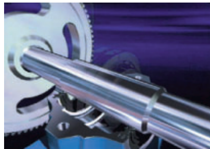
4 Asenna laakerin kierreporauksellinen ulkorengas pesäjalkaan ja kohdistusta akseliin asennettu sisärengas, kiristä sisärenkaan puolikkaat
