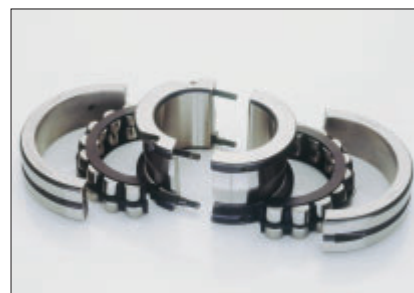
4: Jaettu pallomainen rullalaakeri, jossa on jaettu massiivinen pidin lasikuituvahvisteisesta polyamidista tai messingistä, integroidut kiristysrenkaat
