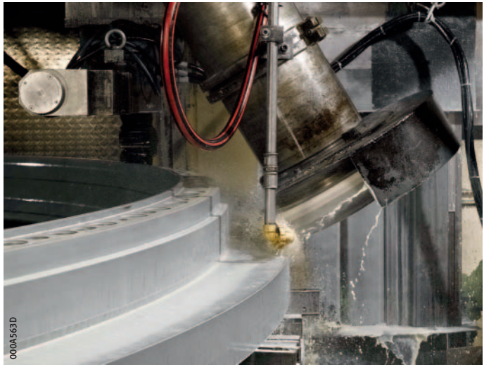
Kuva 7 Suurlaakerin renkaan jälkihiointa
